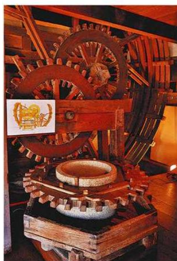
木製動輪の直径が4尺に及ぶ「人車製薬機」
